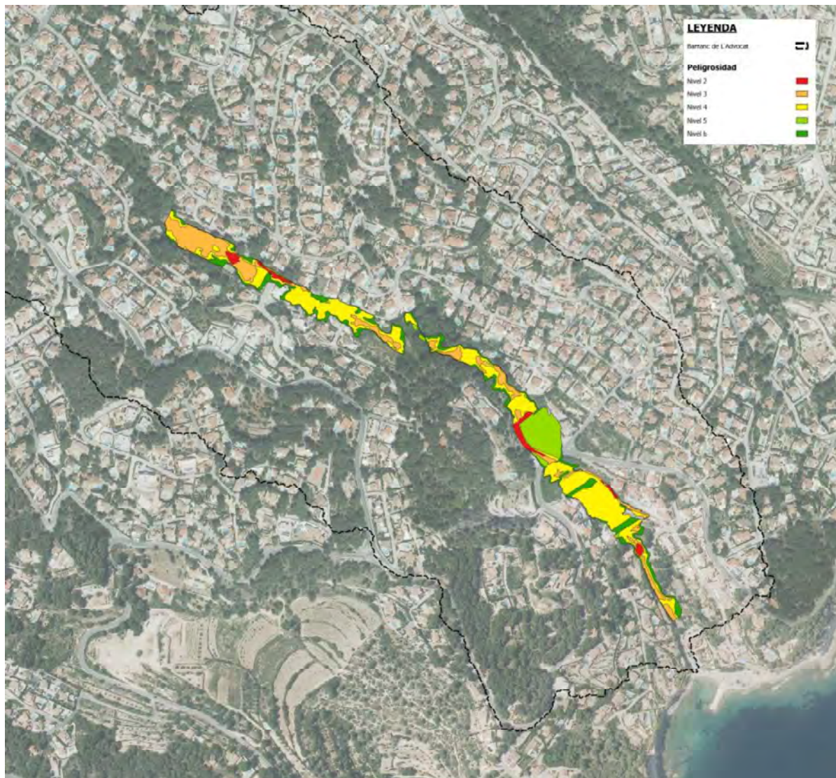
Figura 71. Mapa de peligrosidad de inundación para la cuenca C01-Barranc de la Llobella.
